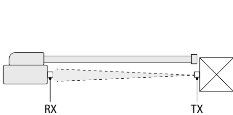
Connexion de couple de photocellules avec fonction Failsafe
