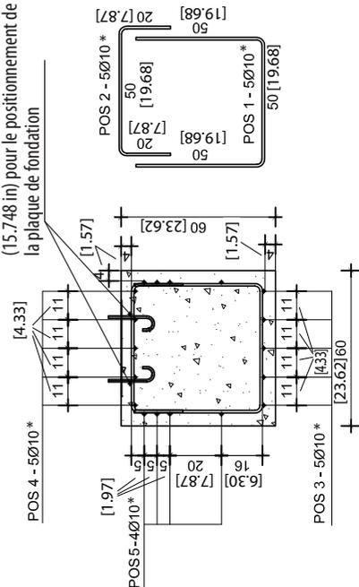
**SECB-B** 2Ø10 L = tiges soudées de 40 cm (15.748 in) pour le positionnement de la plaque de fondation
