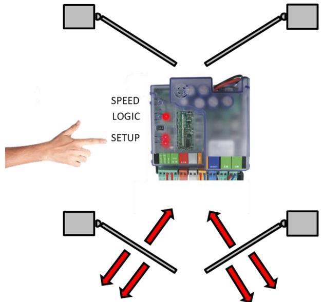
Une fois le SETUP terminé, les voyants A et B du "SETUP" doivent être éteint et **le portail doit être en position ouverte.**
