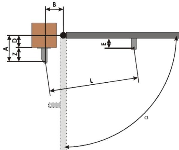
**La fixation avant du bras doit être posée sur la traverse renforcée**
