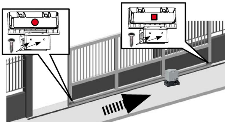
Le fin de course magnétique rond doit être positionné à gauche de l'opérateur
